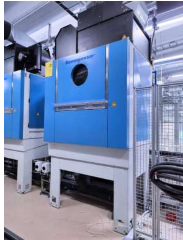
Kuivausrumpu 60kg Kannegiesser
